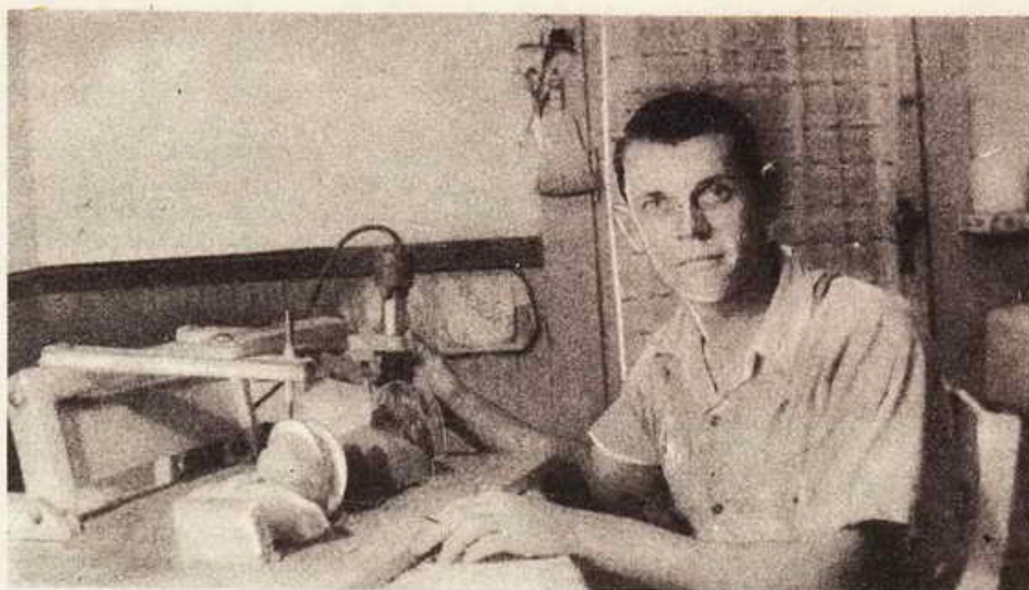
Il pantografo permette la riproduzione di figurine aventi una lunghezza ed una larghezza massima, rispettivamente di cm. 40 e di cm. 20
